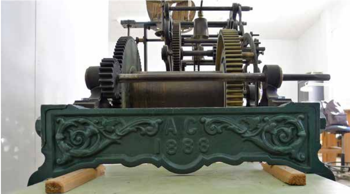
Fig. 4: Soportes del chasis originales con la marca de Canseco y la fecha de fabricación del reloj.
