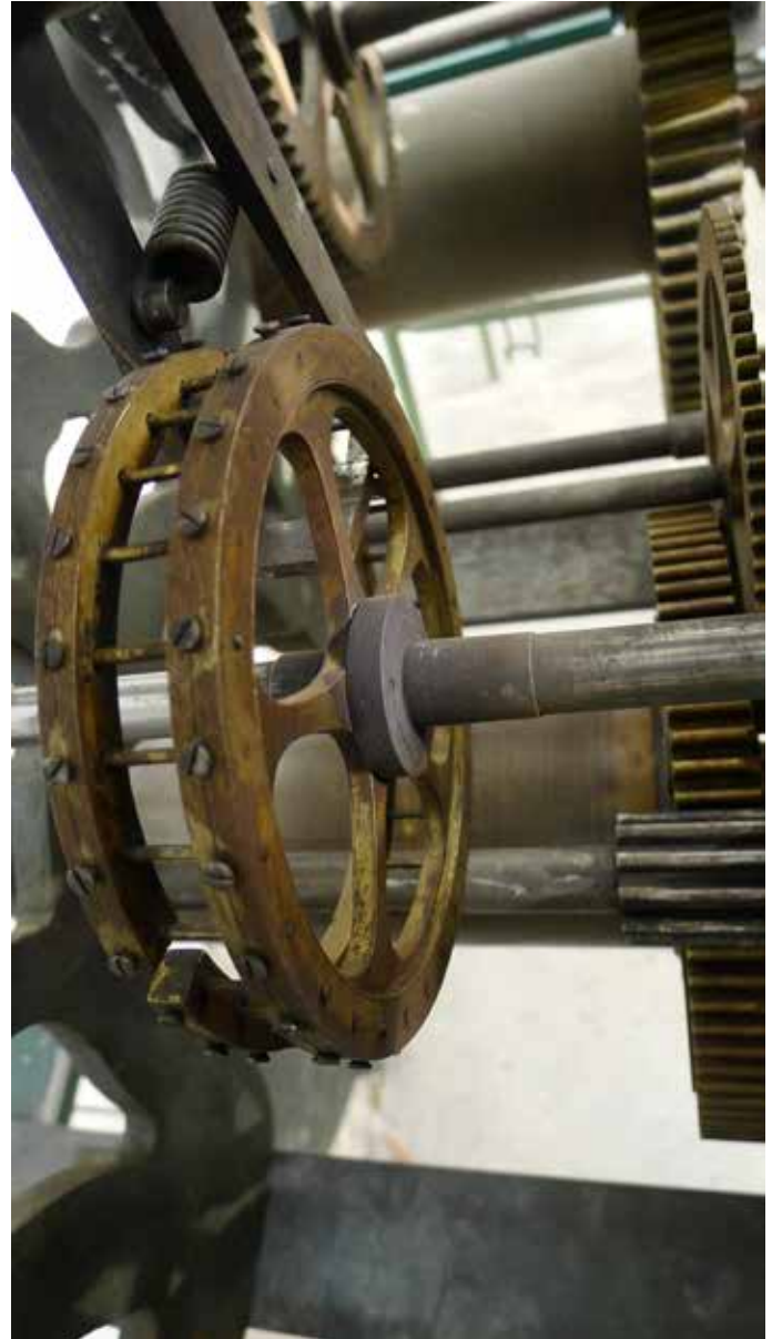
Fig. 8: Rueda de clavijas o de "jaula de ardilla" (rueda de escape).
