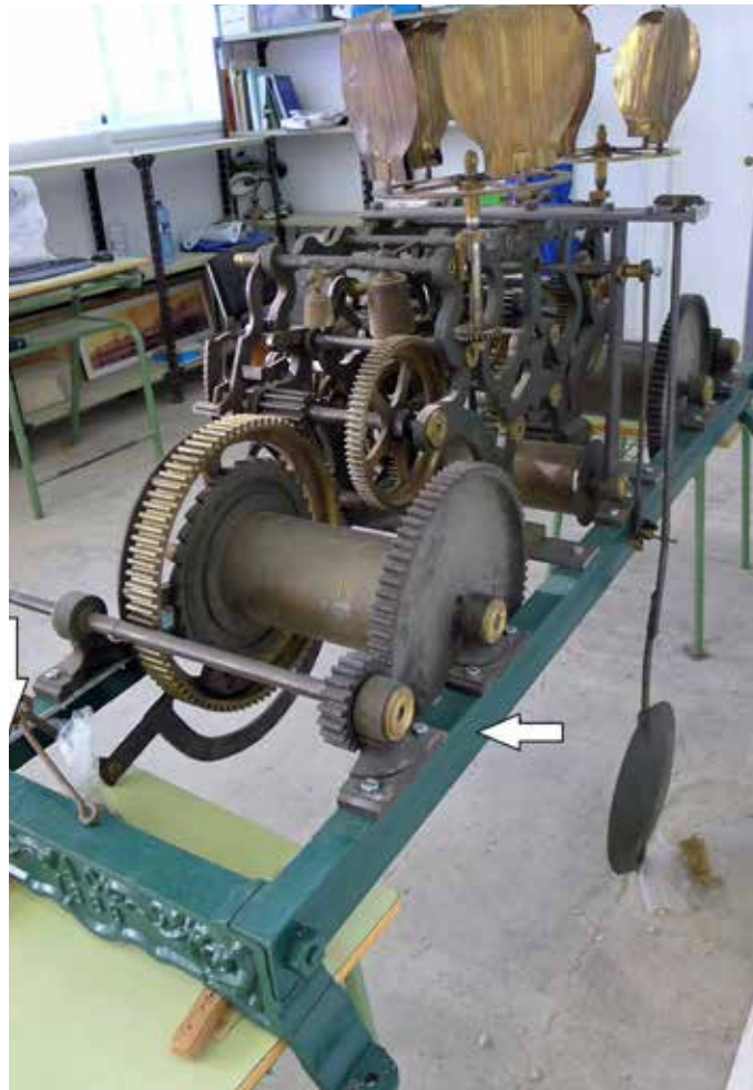
Fig. 3: Los soportes de las barras que están decorados y con la fecha de 1888 son los originales.
