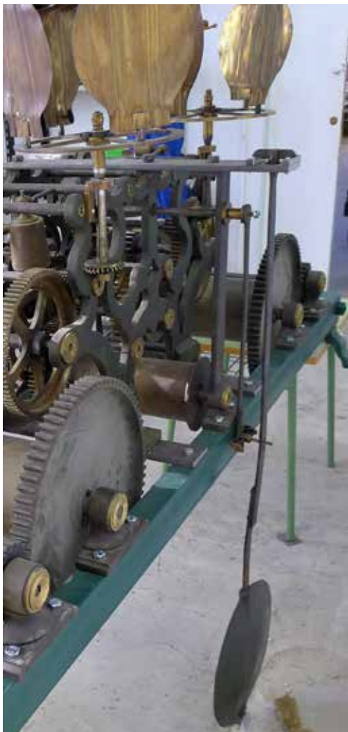
Fig. 9: El péndulo que cumple las especificaciones de un "péndulo real".
