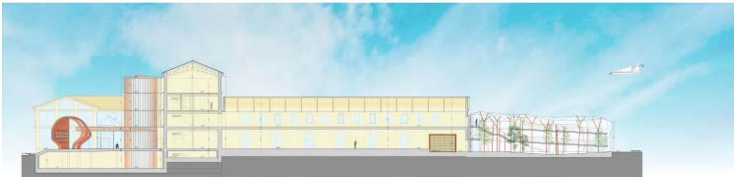
Fig. 5. De izquierda a derecha en Planta Baja, Escultura Hito, Núcleo de Comunicaciones, Sala de Exposiciones Temporales, Sala de Exposiciones Arqueología, Sala del Tesoro y Geoda intercambiador de épocas-Sala de Exposiciones.
