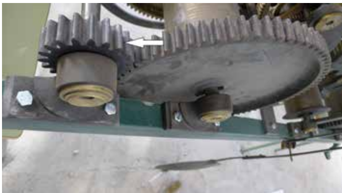
Fig. 14: Uno de los "gatos" para remontar la pesa correspondiente.
