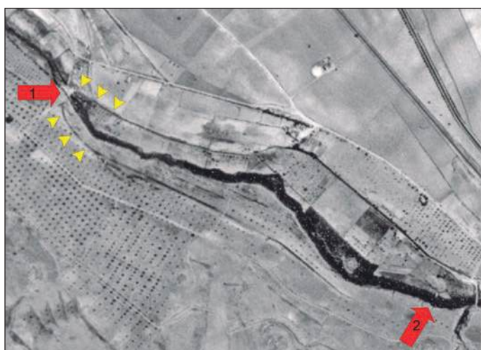
Figura 6: El origen de la red de riegos tradicionales: 1, La Paleta, todavía visible en 1956, donde nacen la Acequia Madre (Hilo del Lugar) y el ramal del Coso (marcados con flechas amarillas en su arranque; 2, La Parada, presa que funcionó hasta el siglo XVIII (elaboración propia).
